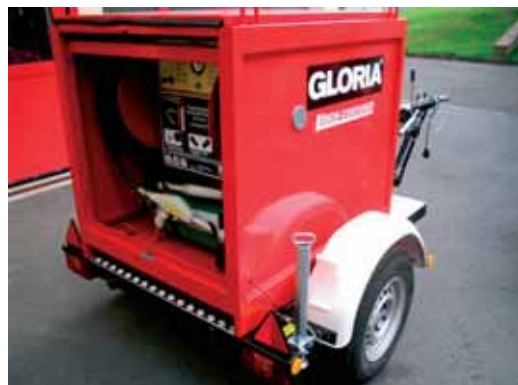
Der neue Pulveranhänger auf Containerbasis
